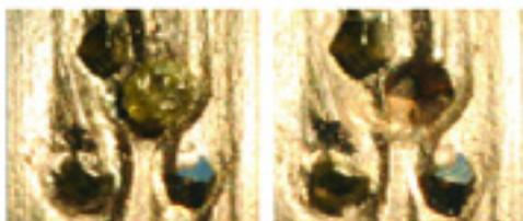
Esempio di diamante (sinistra) rilasciato dalla matrice (destra), probabilmente a causa dell'erosione prodotta dal refrigerante dirottato dai diamanti vicini in modo da accelerare la protrusione / *Example of diamond (left) released by the matrix (right) probably due by the erosion produced by coolant deviated by near diamonds in such a way to accelerate protrusion*
