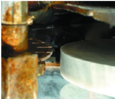
Fig.2 Cippo di marmo (destra) prima dell'esecuzione di solchi con disco diamantato (sinistra)
