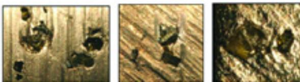
Diamanti fratturati / *Fractured diamonds*
